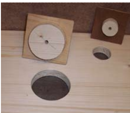
Bild 7: Die Löcher für das Futter und den Zusetzer.
