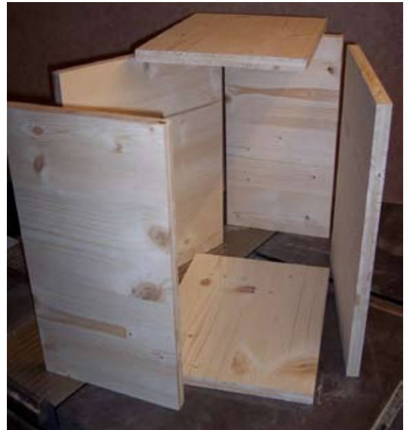
Bild 1: Die 6 Seiten des Ablegerkastens.
